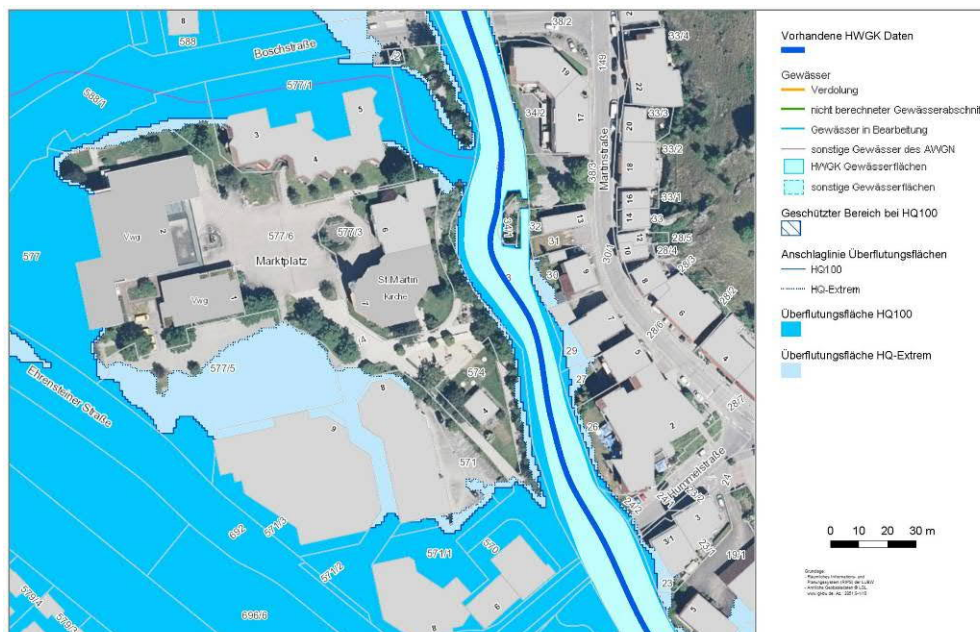
Abbildung 1: Auszug aus den Hochwassergefahrenkarten mit den Überflutungsflächen von HQ 100 und HQ extrem
